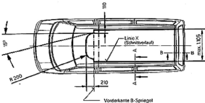
Der große Dachausschnitt wird im Passagier-/Laderaumbereich links/rechts durch die Blechkanten des seitlichen Dachrahmens begrenzt (siehe Schnitt A-A). Im Heckbereich läuft die Schnittkante entlang der Kante des D-Holm-Innenbleches (siehe Schnitt B-B).
