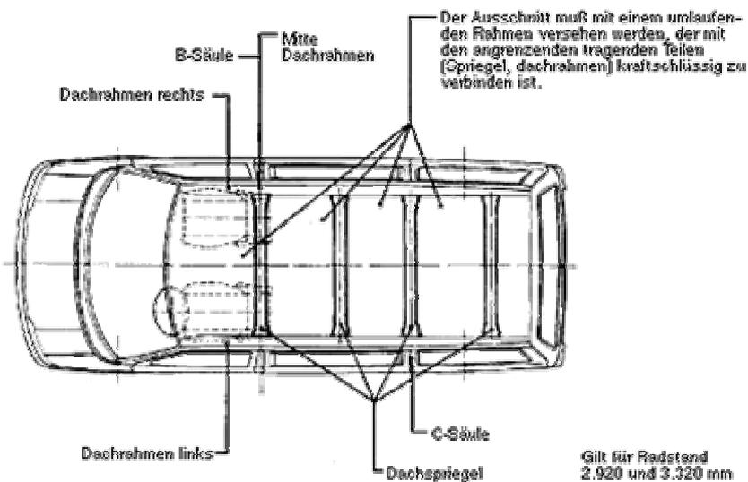
2. Dachausschnitte zwischen den Spiegeln B und C sind nur bei Radstand 2.920 mm zulässig. Details zum hier max. möglichen Dachausschnitt siehe 3.3 Änderungen an geschlossenen Aufbauten. Der Ausschnitt muß links und rechts mit dem angegebenen Verstärkungsblech versehen werden. Die beiden Verstärkungsbleche sind mit dem Dach, den B- und C-Spiegeln sowie mit den Spiegelstummeln des herausgeschnittenen Spiegels (zwischen B- und C-Spiegel) zu verschweißen.
